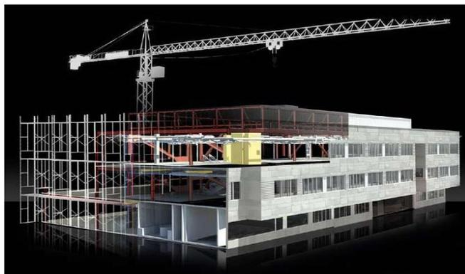
Рисунок 5. Построение 4D модели интерактивного проекта производства работ монтажа модульного здания, как основы для создания 5D на основе BIM технологий
