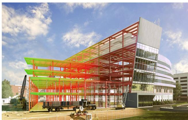
Рисунок 6. Импортированные в ГИС BIM-данные, объединённые в общей 5D модели (координаты, время, движение) проекта производства СМР с возможностью перемещения по объекту, помещённые в «окружающий мир».
