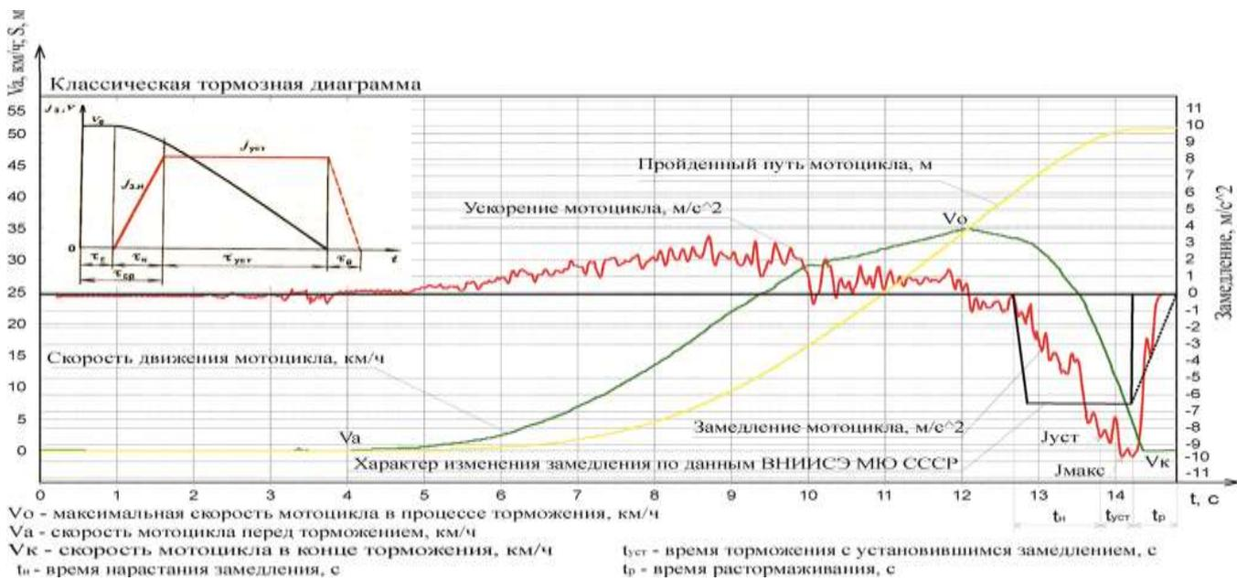
Рис. 1. Тормозная диаграмма на примере мотоцикла марки Yamaha XVS 1100 Drag Star Classic при комбинированном типе торможения, коэффициент сцепления около 0,8, снаряженная масса
