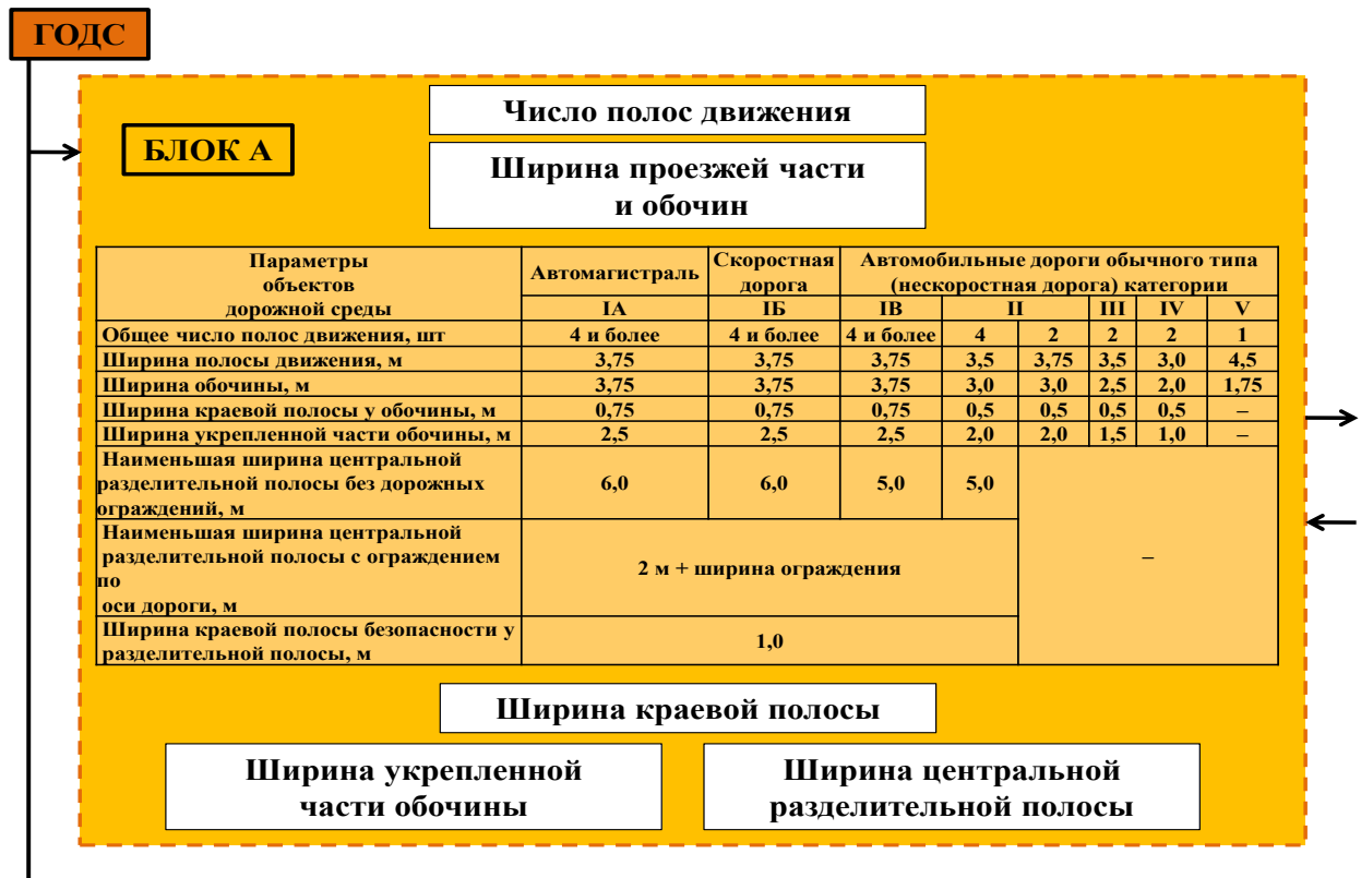
Рисунок 1а. Составляющие параметры Блока А: количество полос движения, ширина проезжей части и обочин, краевой полосы, укрепленной части обочин, разделительной полосы
