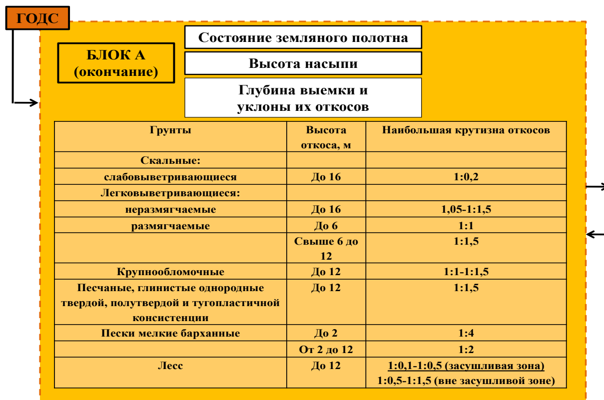
Рисунок 1г. Составляющие параметры Блока А: состояние земляного полотна, высота насыпи, глубина выемок, крутизна откосов
