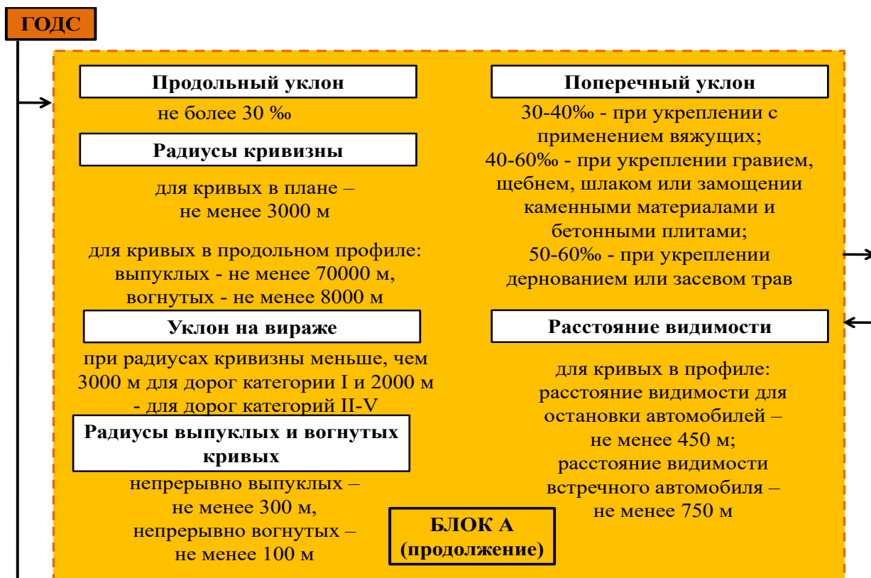
Рисунок 1в. Составляющие параметры Блока А: продольный и поперечный уклоны, на вираже, радиусы кривизны, выпуклых и вогнутых кривых, расстояние видимости
