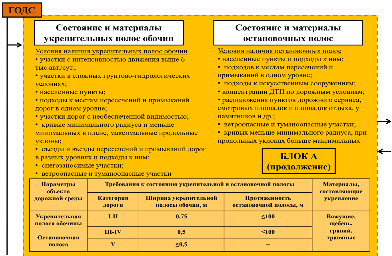
Рисунок 1б. Составляющие параметры Блока А: состояние и материалы укрепительной и остановочной полос
